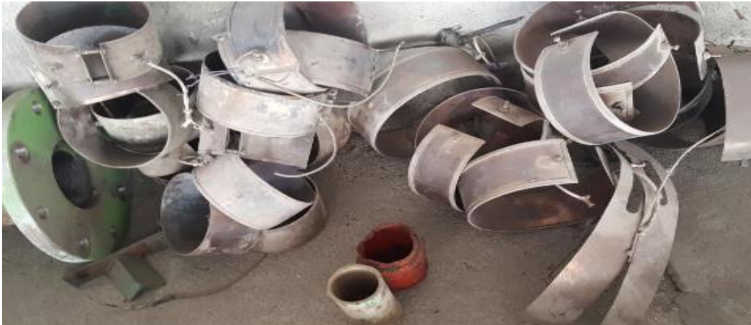
Figura 11.15. Cambio de resistencias térmicas.
