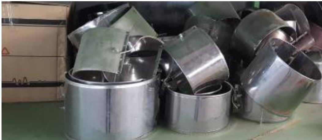
Figura 11.16. Resistencias térmicas nuevas para remplazar.
