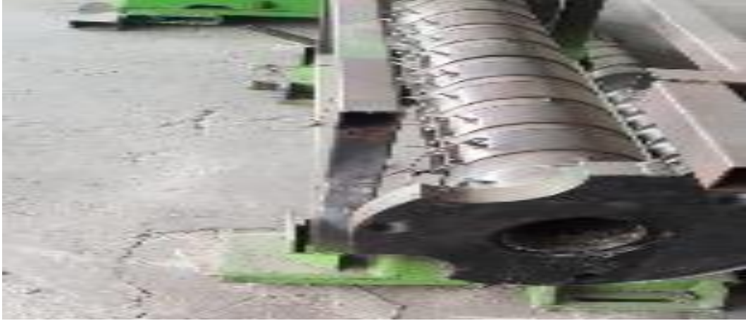
Figura 11.17. Reemplazo de usillo por mal estado.
