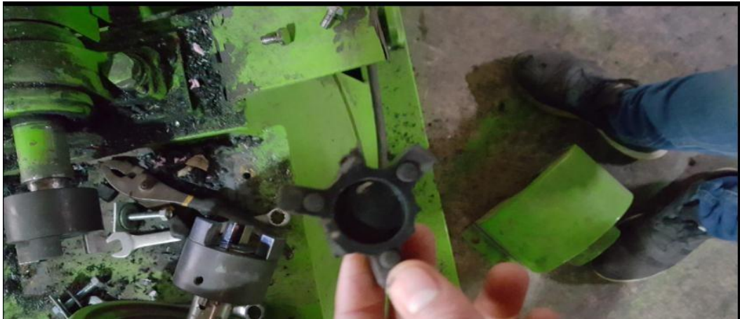
Figura 11.5. Se puede observar el empaque trozado esto provoco mucho ruido ya que existía en contacto desgastando las piezas.
