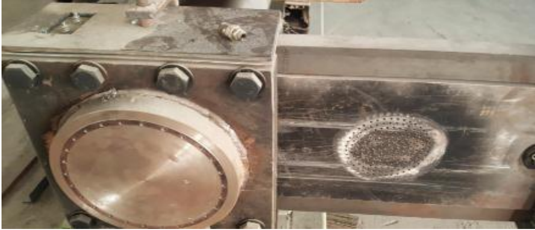
Figura 11.12. Reemplazo de barra porta mallas.
